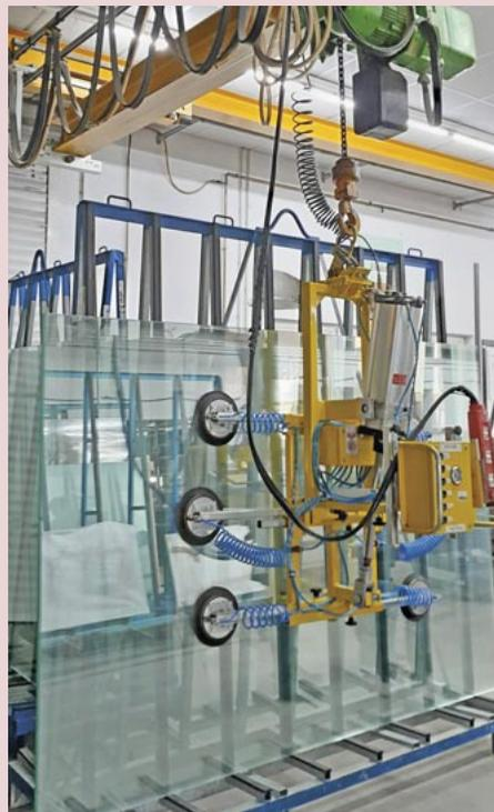
Die angelieferten 2,25 x 1,60m großen Glasplatten werden maschinell auf den Schneidetisch gehoben.
